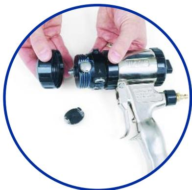
Снимите переднюю крышку для облегчения доступа
