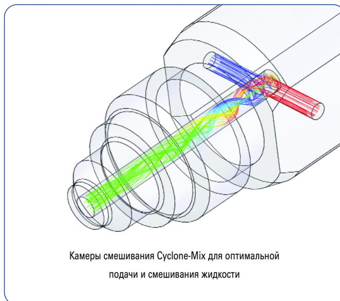
Камеры смешивания Cyclone-Mix для оптимальной подачи и смешивания жидкости
