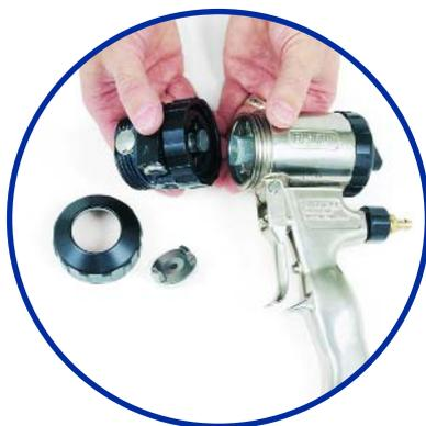
Снимите с распылителя жидкостный блок
